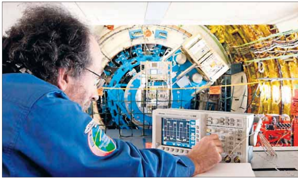
Vom Teleskop sehen die mitreisenden Forscher nur den blauen Ring am Ende der Kabine. Der Physiker Urs Graf kontrolliert während des Fluges die Elektronik. Der Spiegel der fliegenden Sternwarte (re.) ist hinter einem Rolltor in der Wand des Rumpfs eingebaut. Fotos: A. Stirn, Nasa
