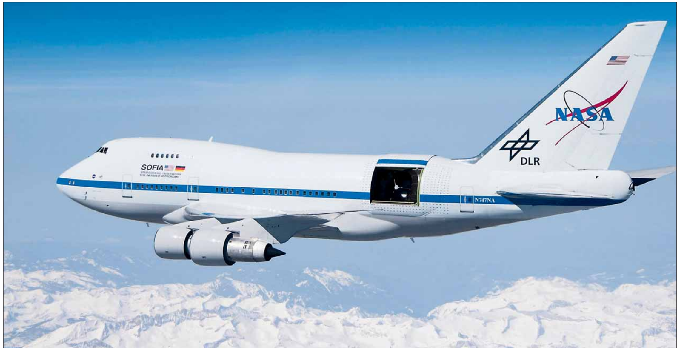
Am fliegenden Observatorium „Sofia“ fällt vor allem der Buckel mit der Klappe hinter den Tragflächen auf. Drückt die Cockpitbesatzung einen Knopf, öffnet sich hier ein Rolltor, damit das eingebaute Infrarot-Teleskop freie Sicht hat. Trotz des Lochs im Rumpf fliegt die umgebaute Boeing 747 aber sehr stabil. Foto: Jim Ross / Nasa
